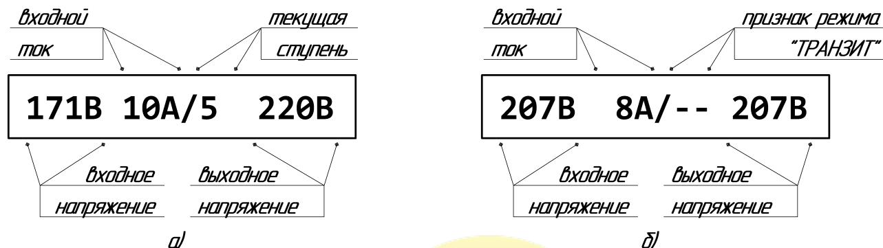
Рисунок 2. Примеры изображений на индикаторе стабилизатора («нулевой экран»)
